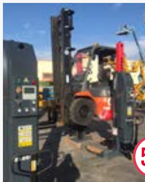
Juego 2 Columnas WIFI (sin cables) de 7.500kg cada una. Total 15.000 kg
