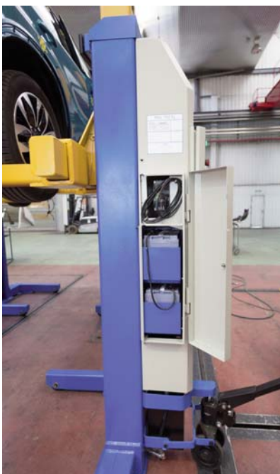
Detalle de la ubicación de las baterías
